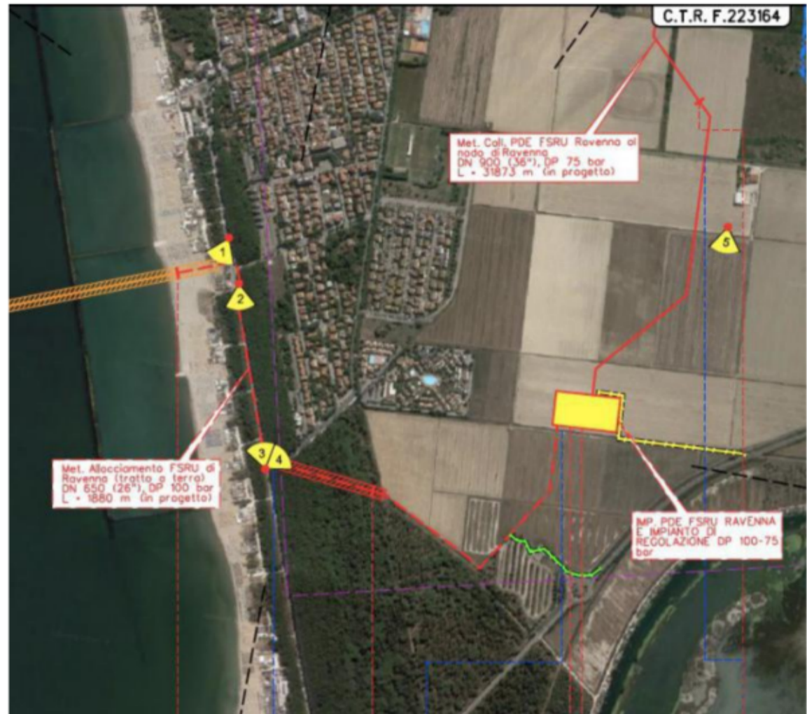
Il tracciato delle condotte a Punta: il passaggio sul lungomare, poi sotto la pineta e poi in zona scambiatore
